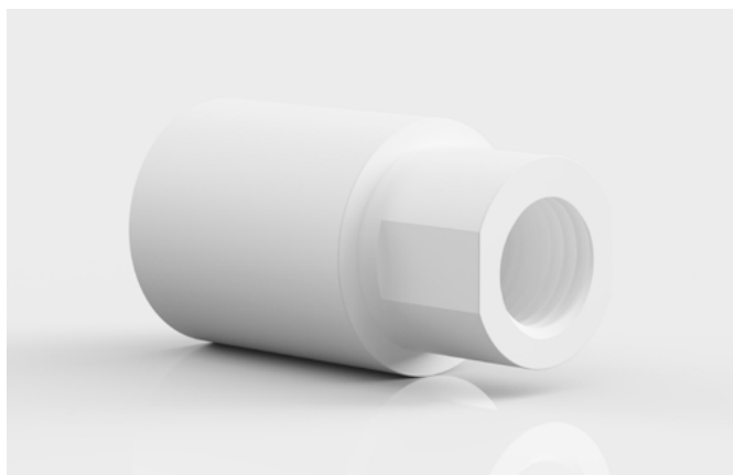
Гайка с резьбой TP 40x5 L=80 мм из ZX-100K выдерживает более 5 тонн нагрузки.
