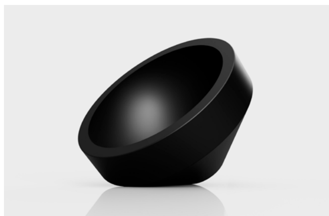
Сферическая опора из ZX-324 с диаметром шарика 60мм. Работа без смазки при температуре до 250°C, нагрузке до 30 тонн с ударами и при наличии загрязнений.
